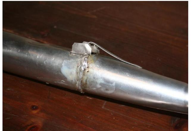
Nahtstellen mangelhaft gelötet bzw. überhaupt nur geklebt
